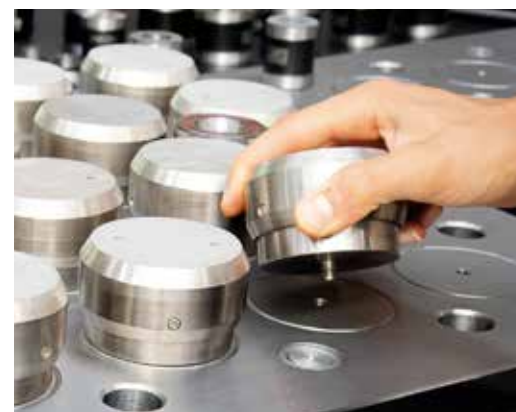
Espansioni polari mobili - Mobile pole chucks
