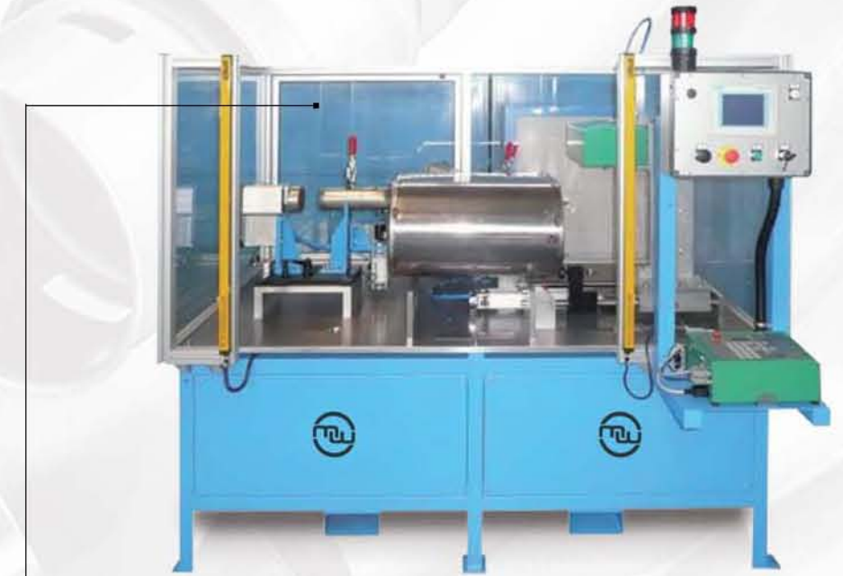
Leak testing and marking unit. Druckverlust-Prüfmaschine mit Markierung. Unité d'étanchéité et marquage.
